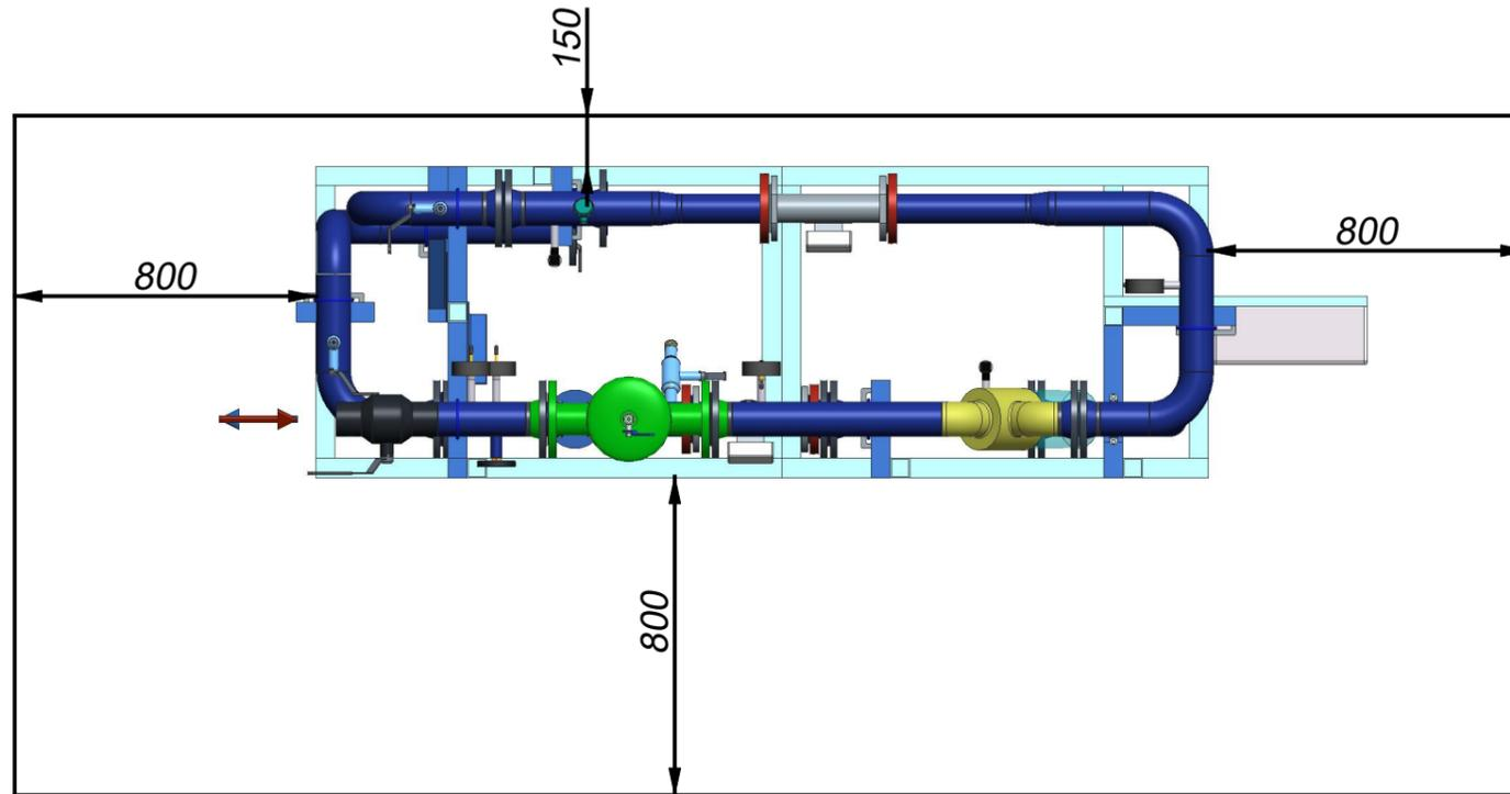
На данном виде область вокруг блока показана рекомендованная зона обслуживания БТП. БТП следует размещать, выдерживая указанные расстояния от стен или другого оборудования, для обеспечения этой зоны.
